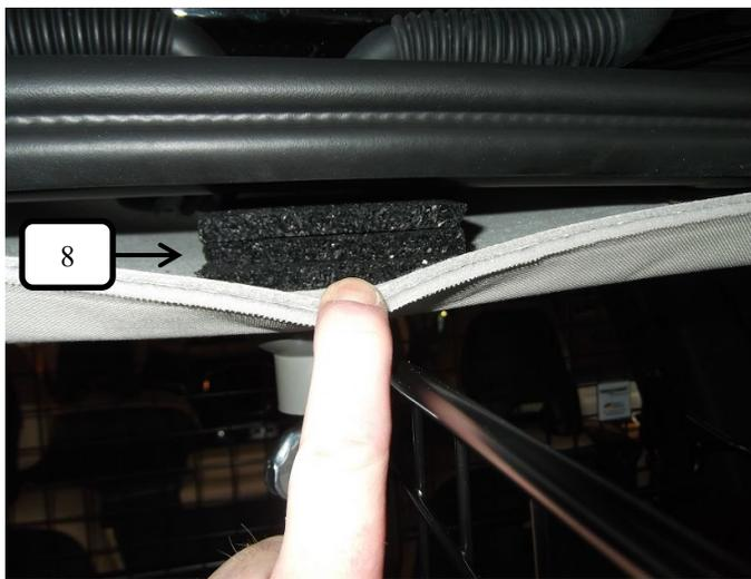
Im oberen Bereich der Heckklappe die Gummiabdichtung leicht anheben und je nach gewünschter Position des Teilers die Gummimunterlagen 8mm (Pos.8) im Bereich des Feststellpunktes in den Hohlraum schieben.
