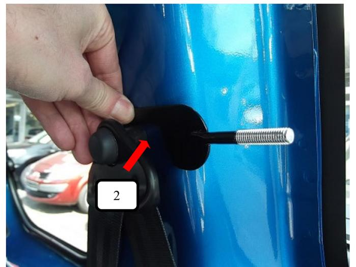
Gewindehaken (Pos. 2) an der Gurthalterung einhängen.
