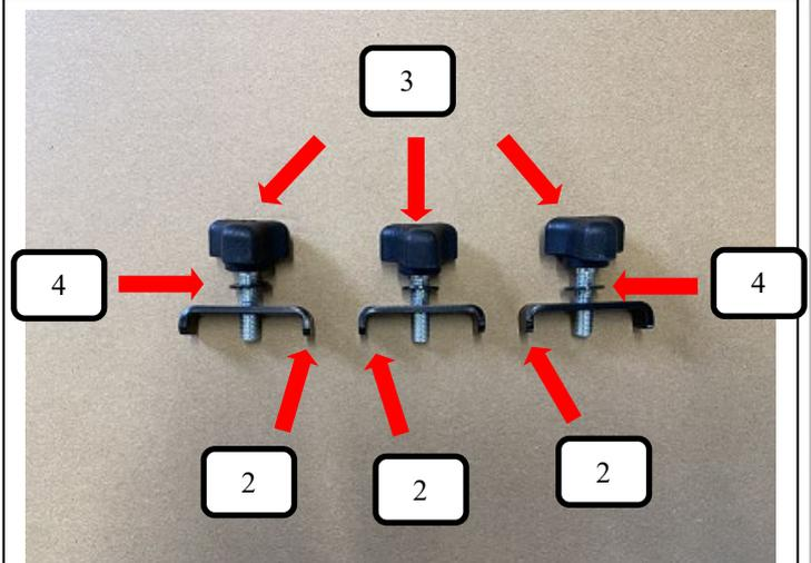
Die drei U-Bügel (Pos.2) zusammen jeweils einer Unterlegscheibe (Pos.4) und Rändelschraube (Pos.3) wie im Bild dargestellt zusammenstecken.
