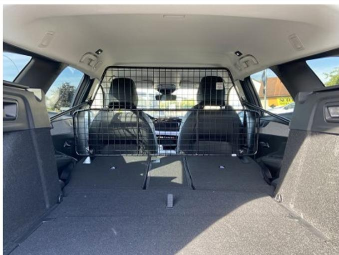
Trenngitter im montierten Zustand.
