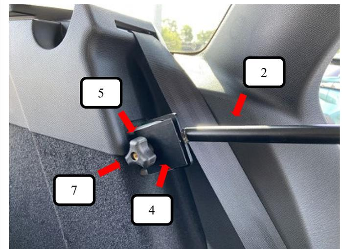
Seitenstrebe (Pos. 2) mit einer Schlossschraube (Pos. 6), Unterlegscheibe (Pos. 5) und Rändelmutter flach (Pos. 7) am Trenngitter (Pos. 1) befestigen und festziehen.
