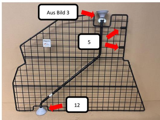
Wie im Bild dargestellt, bitte die aus Bild 3 zusammengesteckte Gewindestange mit Gummifuß oben in die Rohröffnung des Teilers (Pos. 1) stecken (Feststellpunkt) und einen Gummifuß (Pos.12) unten am Teiler aufstecken. Beide Rohrendkappen (Pos. 5) auf den Raumteiler drücken.
