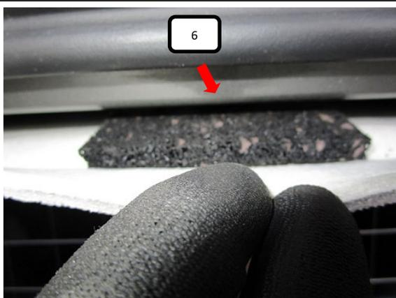
Im oberen Bereich der Heckklappe die Gummiabdichtung leicht anheben und je nach gewünschter Position des Teilers die 2 beigelegte Gummimatten (Pos.6) im Bereich des Feststellpunktes in den Hohlraum schieben.
