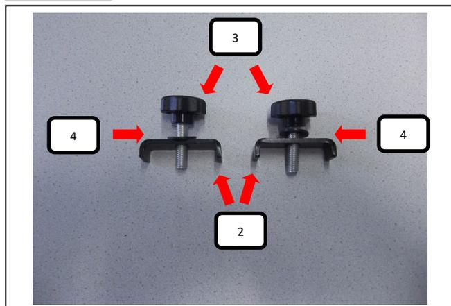
Die beiden U-Bügel (Pos.2) zusammen jeweils einer Unterlegscheibe (Pos.4) und Rändelschraube (Pos.3) wie im Bild dargestellt zusammenbauen.
