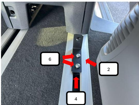
Jetzt den Bodenhalter L+R (Pos. 2) mittels zwei Inbusschrauben M8x30 (Pos. 6) mit der gegenplatte für Bodenhalter (Pos. 4) verbinden und festziehen.
