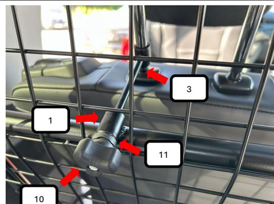
Kunststoffhülse (Pos. 11) in das Trenngitter (Pos. 1) drücken. Jetzt die Kopfstützen rausnehmen und diese durch die Gewindestange für Kopfstütze (Pos. 3) schieben, danach die Kopfstützen wieder in der Sitz einschieben. Nun die Gewindestange für Kopfstütze (Pos. 3) durch das Trenngitter (Pos. 1) und Kunststoffhülse (Pos. 11) stecken, von der andere Seite die Rändelmutter gewölbt (Pos. 10) aufschrauben und festziehen.
