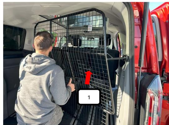
Trenngitter (Pos. 1) von hinten aus schräg in das Fahrzeug einbringen, hinter der C-Säule platzieren und mit dem unteren Bereich vor dem im Bild 5 montierten Bodenhalter L+R (Pos. 2) stellen.
