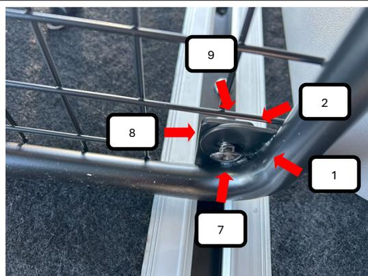
Schlossschraube M88x20 (Pos. 7), durch das Trenngitter (Pos. 1) und Bodenhalter L+R (Pos. 2) stecken, von der anderen Seite ein Unterlegscheibe M8 (Pos. 8) und Rändelmutter flach (Pos. 9) ausschrauben und festziehen.
