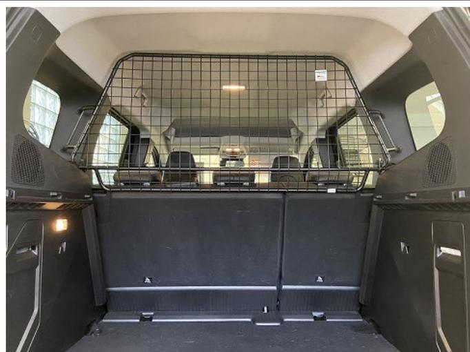
Trenngitter im montierten Zustand.
