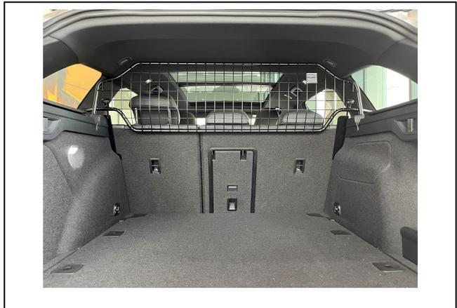
Trenngitter im montierten Zustand.
