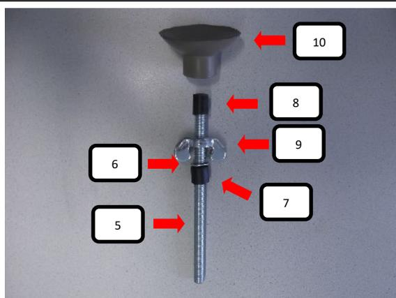
Auf die Gewindestange oben (Pos. 5) die Distanzhülse (Pos. 8) und danach den Gummifuß (Pos. 10) aufstecken. Von der anderen Seite die Flügelmutter (Pos. 9) aufdrehen und dann die U-Scheibe (Pos. 10) und Durchführungsschutzkappe (Pos. 7) aufschieben.
