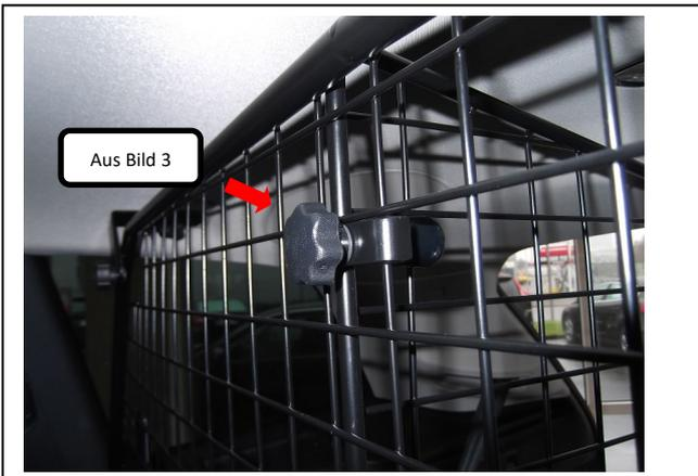
Nun den Teiler mittels der drei Verschraubungen aus Bild 4 oben und unten am Trenngitter befestigen.
