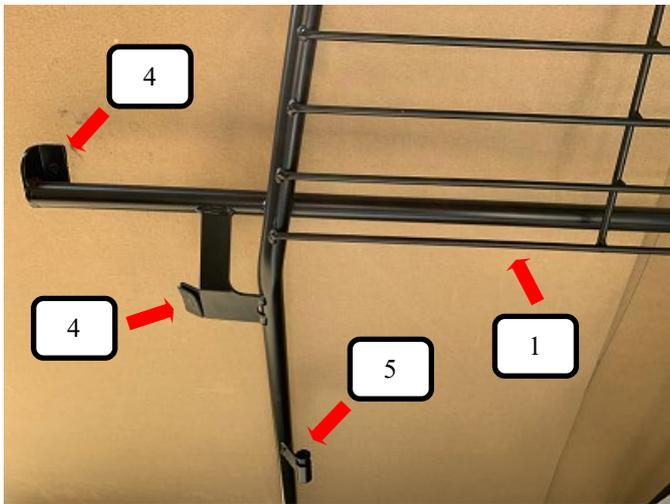
Gummiauflage klein (Pos. 4) auf das Trenngitter (Pos. 1) und Kunststoffhülse (Pos. 5) in das Trenngitter (Pos. 1) stecken.
