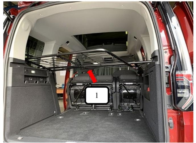
Trenngitter (Pos. 1) wie auf dem Bild schräg von hinten in das Fahrzeug einbringen.
