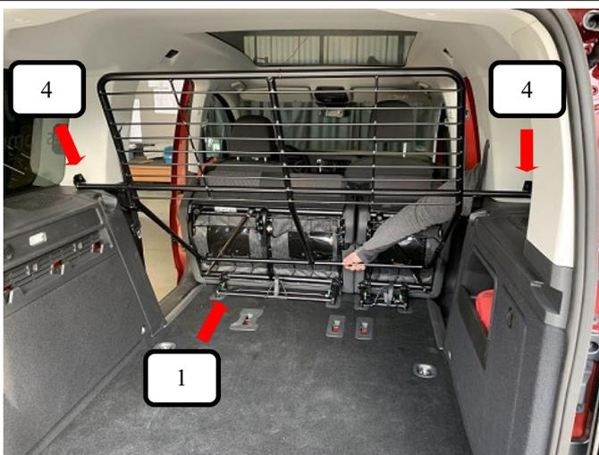
Trenngitter (Pos. 1) mit den vormontierten Gummiauflagen klein (Pos. 4) wie auf dem Bild hinter der C-Säule platzieren und nach unten drehen.
