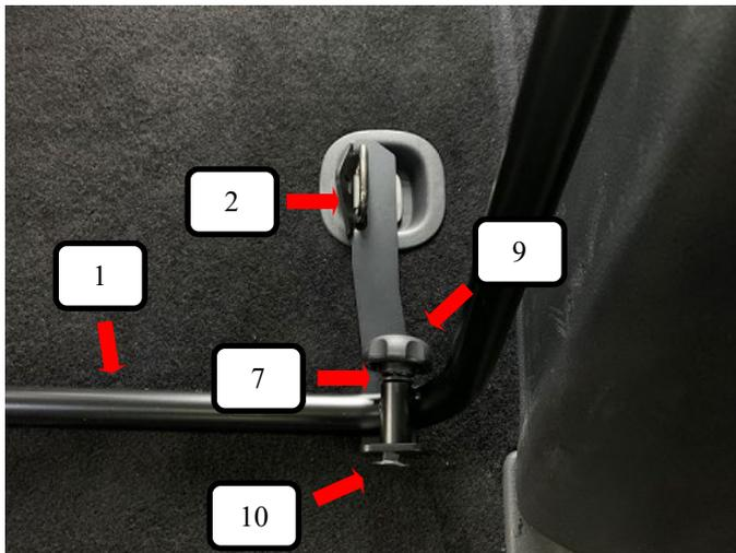
Verzurröse aufrecht stellen und den Bodenhalter links + rechts (Pos. 2) über die Verzurröse führen, das Trenngitter (Pos. 1) steht dann auf dem Bodenhalter links + rechts (Pos. 2). Jetzt von vorne eine Schlossschraube (Pos. 10) durch den Bodenhalter links + rechts (Pos. 2) und das Trenngitter (Pos. 1) stecken, von der anderen eine Unterlegscheibe (Pos. 7) und Rändelmutter groß (Pos. 9) aufschrauben und festziehen.
