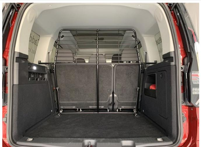
Trenngitter im montierten Zustand.
