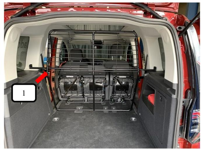
Trenngitter (Pos. 1) richtig positioniert.
