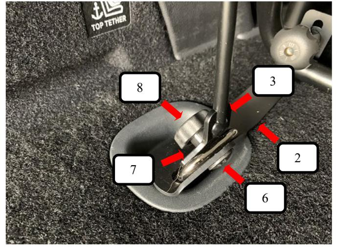
Gewindestange (Pos. 3) von außen an die Verzurröse halten und oben durch das Trenngitter (Pos. 1) sowie Kunststoffhülse (Pos. 5) schieben, von innen die Schlossschraube (Pos. 6) durch den Bodenhalter (Pos. 2) und Gewindestange (Pos. 3) stecken. Jetzt von der anderen Seite eine Unterlegscheibe (Pos. 7) und Rändelmutter klein (Pos. 8) aufschrauben und festziehen.
