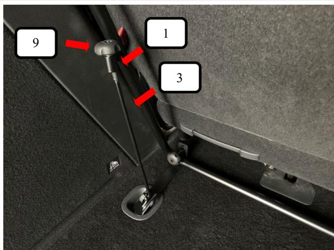
Rändelmutter groß (Pos. 9) auf die Gewindestange (Pos. 3) aufschrauben und festziehen.
