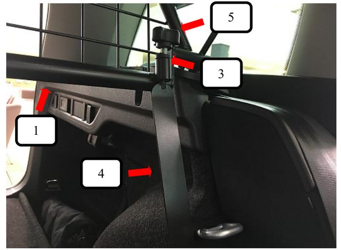
Gewindehaken (Pos. 4) über die Rücksitzbankarretierung schieben und dann nach oben mit dem Gewinde durch das Trenngitter (Pos. 1) sowie Kunststoffhülse (Pos. 3) stecken. Jetzt eine Rändelmutter (Pos. 5) aufschrauben und festziehen.
