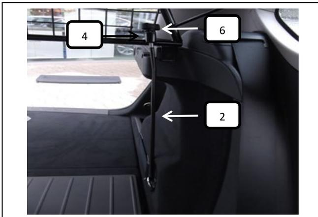
Den Gewindehaken (Pos.2) jeweils rechts und links in die Verzurrösen Halterung einhängen durch die Kunststoffhülse (Pos.6) am Trenngitter führen, Trenngitter ausrichten und mit der Rändelmutter (Pos.4) befestigen. **Achtung!!! Achten Sie bitte auf die Plananlage der Schutzkappe 25° an der C-Säule**
