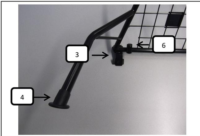
Wie im Bild dargestellt rechts und links am Trenngitter jeweils die Schutzkappe 25° (Pos.4), sowie je 2x Gummiauflage klein (Pos.3) aufstecken. Die Kunststoffhülse (Pos.6) von oben in die Hülse stecken.
