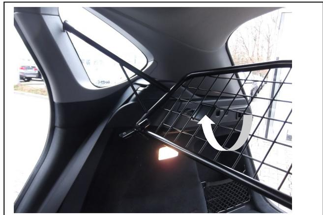
Trenngitter von der Rücksitzbank aus waagrecht mit den Streben nach oben in den Kofferraum des Fahrzeuges bringen, senkrecht aufstellen (ggf. Gitter etwas nach rechts oder links bewegen) so dass die Schutzkappe 25° sich rechts und links an der C-Säule und die Gummiauflage klein auf der Kunststoffverkleidung der Kofferraumabdeckung abstützen kann.
