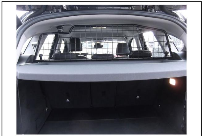
Trenngitter im montierten Zustand.
