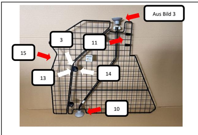
Wie im Bild dargestellt, bitte die aus Bild 3 zusammengesteckte Gewindestange mit Gummifuß oben in die Rohröffnung des Teilers (Pos. 1) stecken (Feststellpunkt) und einen Gummifuß (Pos.10) unten am Teiler aufstecken. Beide Rohrendkappen (Pos. 11) auf den Raumteiler drücken. Den Aufsatz (Pos. 15) an allen 3 Positionen, mit einer Schlossschraube M8x20 (Pos. 13), Unterlegscheibe M8 (Pos. 3) und Rändelmutter flach (Pos. 14) am Raumteiler (Pos. 1) fixieren und festziehen.
