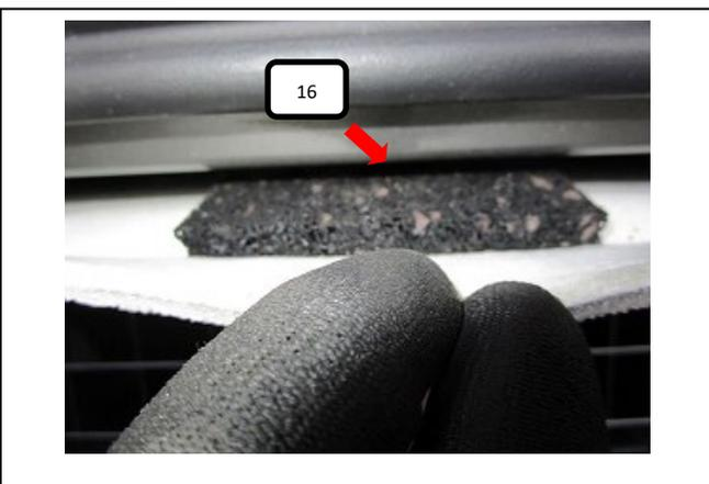
Im oberen Bereich der Heckklappe die Gummiabdichtung leicht anheben und je nach gewünschter Position des Teilers die beigelegte Gummimatte (Pos. 16) im Bereich des Feststellpunktes in den Hohlraum schieben.
