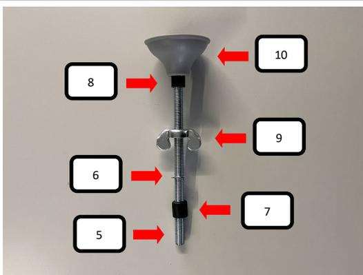
Auf die Gewindestange (Pos. 5) die Distanzhülse (Pos. 8) und danach den Gummifuß (Pos. 10) aufstecken. Von der anderen Seite die Flügelmutter (Pos. 9) aufdrehen und dann die U-Scheibe (Pos. 6) und Durchführungsschutzkappe (Pos. 7) aufschieben
