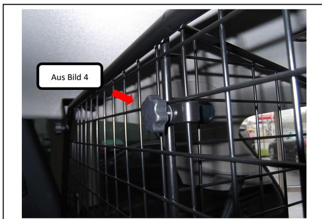
Nun den Teiler mittels der beiden Verschraubungen aus Bild 4 oben und unten am Trenngitter befestigen.
