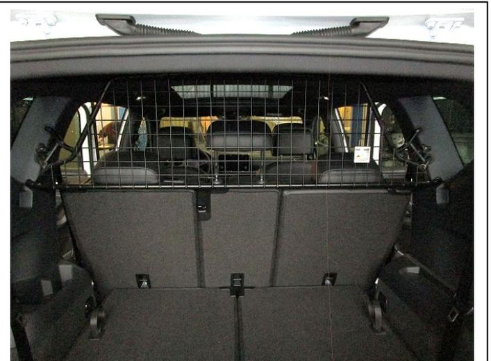
Trenngitter im montierten Zustand.
