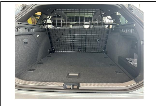
Trenngitter im montierten Zustand, Ladeboden eben.
