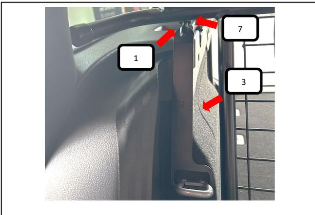
Gewindehaken L+R (Pos. 3) etwas durch die Kunststoffhülse (Pos. 7) und das Trenngitter (Pos. 1) schieben, jetzt die Unterseite über die Rücksitzbankarretierung führen.
