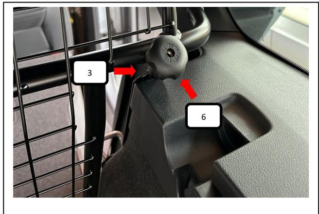
Von oben die Rändelmutter gewölbt (Pos. 6) auf den Gewindehaken L+R (Pos. 3) aufschrauben und festziehen.
