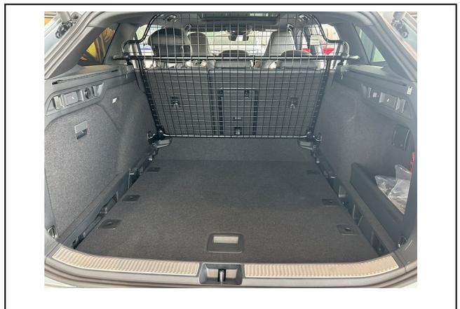
Trenngitter im montierten Zustand, Ladeboden tief.
