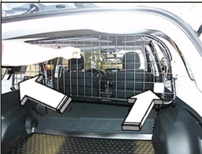
Trenngitter in das Fahrzeug einbringen.
