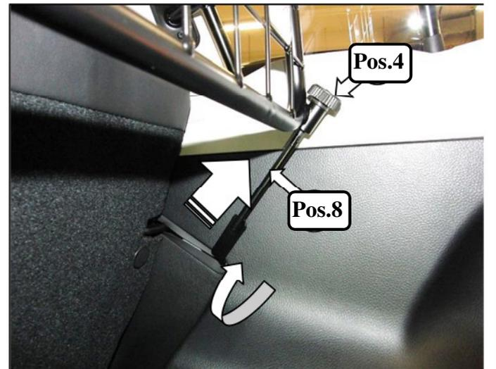
Gewindehaken Pos.8 in den Schlitz der Seitenverkleidung einhängen, und mit der Gewindestange durch die Hülse am Trenngitter stecken. Rändelmutter Pos.4 aufschrauben bis Trenngitter spielfrei sitzt.
