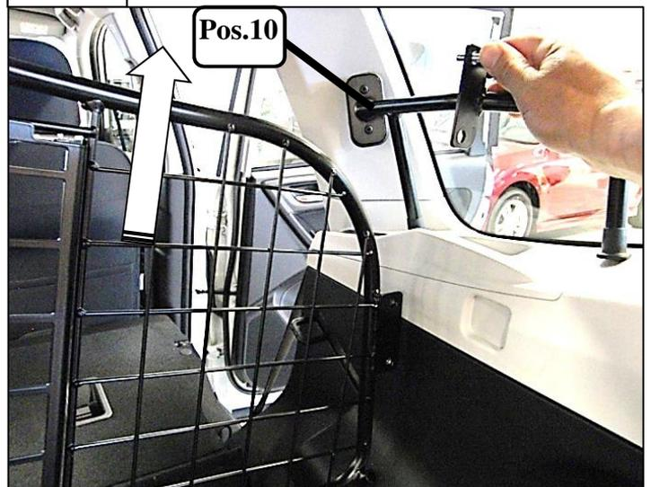
Rechte Abstützung Pos.10 am Trenngitter montieren.
