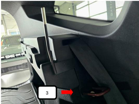
Gewindehaken L+R (Pos. 3) über die Rückbankankeringführung führen.
