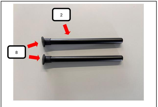
Gummifuß 25° (Pos. 8) auf das 16er Rohr mit Innengewinde (Pos. 2) drücken, bitte darauf achten, dass es die Seite ohne Innengewinde ist.
