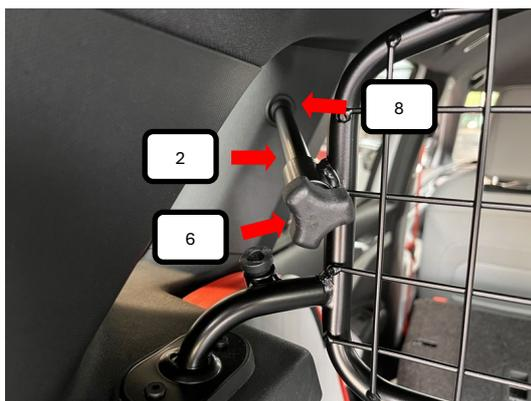
Nun die Rändelschraube M8x30 (Pos. 6) reindreihen und festziehen, es muss darauf geachtet werden, dass der Gummifuß 25° (Pos. 8) der Schräge der C-Säule angepasst ist.
