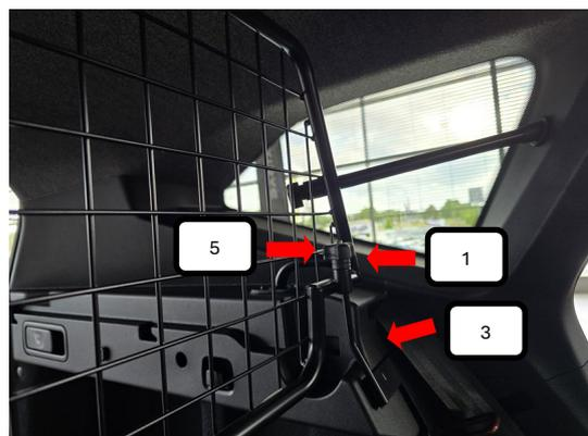
Gewindehaken L+R (Pos. 3) Gewinde durch das Trenngitter (Pos. 1) stecken (Gitter muss dafür leicht angehoben werden).
