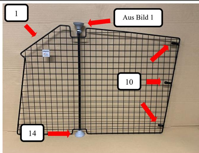
Wie im Bild dargestellt bitte die aus Bild 1 zusammengesteckte Gewindestange mit Gummifuß oben in die Rohröffnung des Teilers stecken (Feststellpunkt) und einen Gummifuß (Pos.14) unten am Teiler aufstecken. Rohrendkappen (Pos. 10) auf den Teiler (Pos. 1) drücken.
