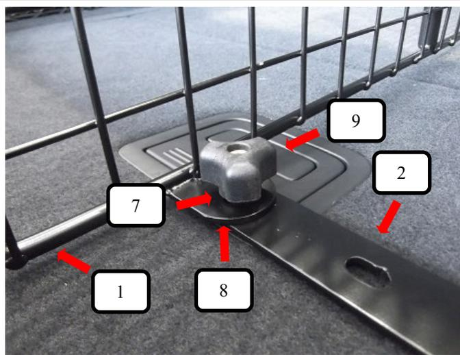
Teiler (Pos. 1) in das Fahrzeug einbringen und die Position auswählen. Von unten eine Schlossschraube (Pos. 8) durch den Bodenhalter mit Gewinde (Pos. 2) und den Teiler (Pos. 1) stecken, jetzt von oben eine Unterlegscheibe (Pos. 7) und Rändelmutter flach (Pos. 9) aufschrauben und festziehen.
