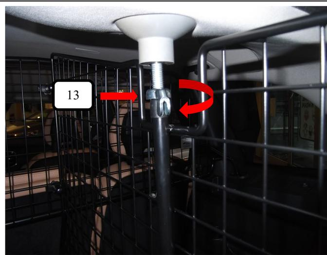
Oberen Feststellpunkt über drehen der Flügelmutter (Pos. 13) (Uhrzeigersinn) leicht anziehen.
