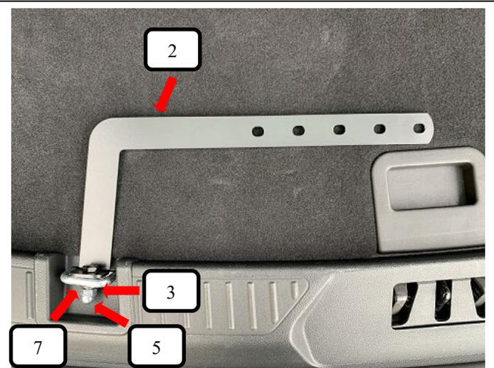
Bodenhalter mit Gewinde (Pos. 2) wie auf dem Bild mit dem Gewinde durch die Verzurröse schieben, von der anderen Seite die Gegenplatte (Pos. 3), Unterlegscheibe (Pos. 7) und Hutmutter M8 (Pos. 5) aufschrauben und festziehen.
