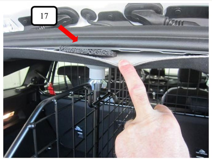
Im oberen Bereich der Hecktür die Gummiabdichtung leicht anheben und je nach gewünschter Position des Teilers 2 x die Gummimunterlagen 8mm (Pos.17) im Bereich des Feststellpunktes in den Hohlraum schieben.
