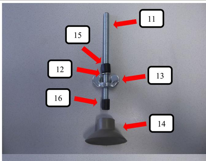
Als erstes die Distanzhülse (Pos. 16) auf die Gewindestange (Pos.11) und dann den Gummifuß grau (Pos.14) wie im Bild dargestellt aufstecken. Danach die Flügelmutter (Pos. 13) drauf drehen und die Unterlegscheibe (Pos. 12), sowie die Distanzhülse (Pos. 15) aufstecken.
