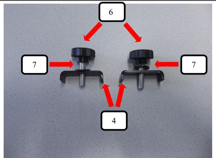
Die beiden U-Bügel (Pos.4) zusammen jeweils einer Unterlegscheibe (Pos.7) und Rändelschraube (Pos.6) wie im Bild dargestellt zusammenbauen.
