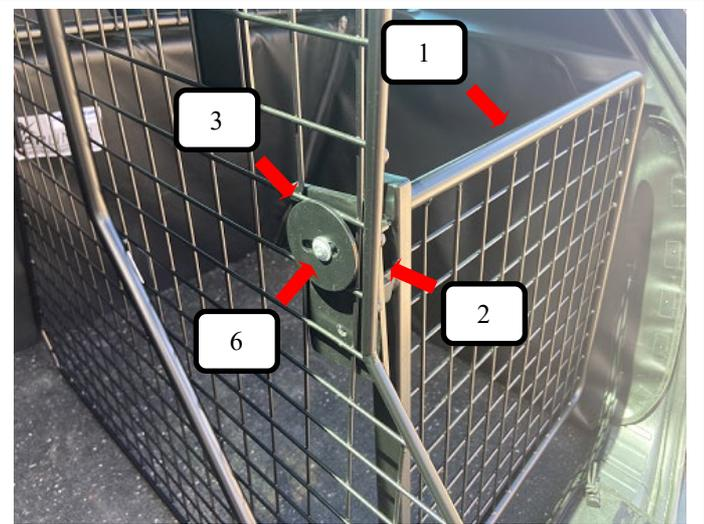
Hecktür (Pos. 1) mit vormontierter Aufhängung (Pos. 2) aus Bild 1, von der einen Seite an den Raumteiler halten und an beiden Positionen von der anderen Seite die Gegenplatte (Pos. 3) dranhalten. Jetzt jeweils mit der Inbusschraube klein (Pos. 6) verbinden und festziehen.
