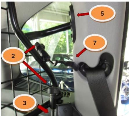
Trenngitter in das Fahrzeug einbringen und an der C-Säule ausrichten. Gewindehaken (Pos. 7&8) in die hintere Ecke der Gurtaustrittsöffnung einhaken und durch die oberen Kunststoffhülsen (Pos.4) am Gitter stecken. Mit Rändelmutter (Pos.2) leicht anziehen
