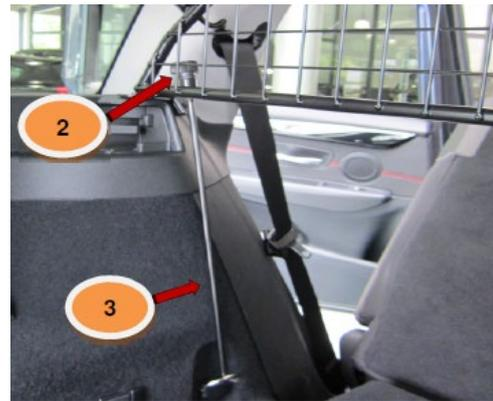
Anschließend Gewindestange Pos.3 in die Verzurrösen einhängen und durch die unteren Hülsen (Pos. 4) stecken. Rändelmutter (Pos. 2) aufschrauben. Trenngitter gleichmäßig ausrichten und alle Rändelmutter anziehen.
