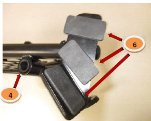
Schutzauflage (Pos. 6) aus das Trenngitter (Pos. 1) und Kunststoffhülse (Pos. 4) in das Trenngitter (pos. 1) stecken.
