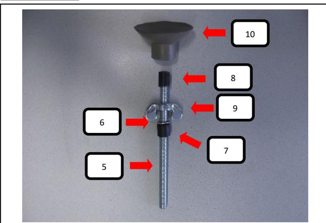
Auf die Gewindestange oben (Pos. 5) die Distanzhülse (Pos. 8) und danach den Gummifuß (Pos. 10) aufstecken. Von der anderen Seite die Flügelmutter (Pos. 9) aufdrehen und dann die U-Scheibe (Pos. 10) und Durchführungsschutzkappe (Pos. 7) aufschieben
