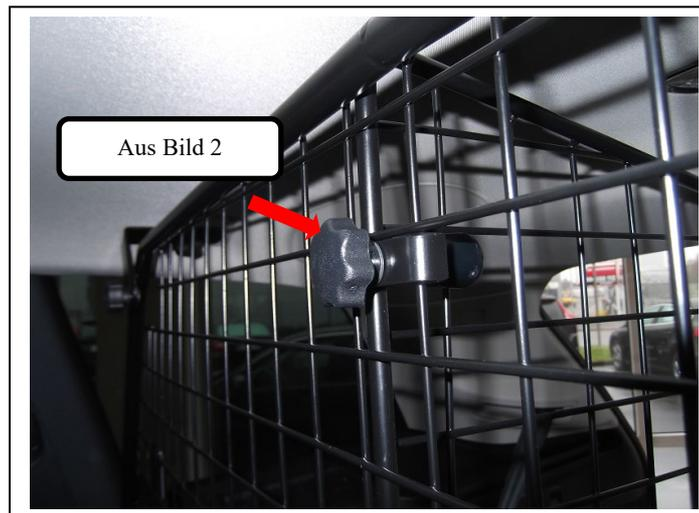
Nun den Teiler mittels der beiden Verschraubungen aus Bild 2 oben und unten am Trenngitter befestigen.
