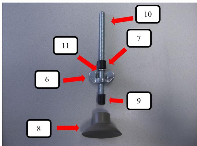
Die Gewindestange oben (Pos.10) auf einen Gummifuß grau (Pos.8) wie im Bild dargestellt auf stecken. Danach die Flügelmutter (Pos. 6) drauf drehen und die Unterlegscheibe (Pos. 11), sowie die Distanzhülse (Pos. 7) aufstecken.
