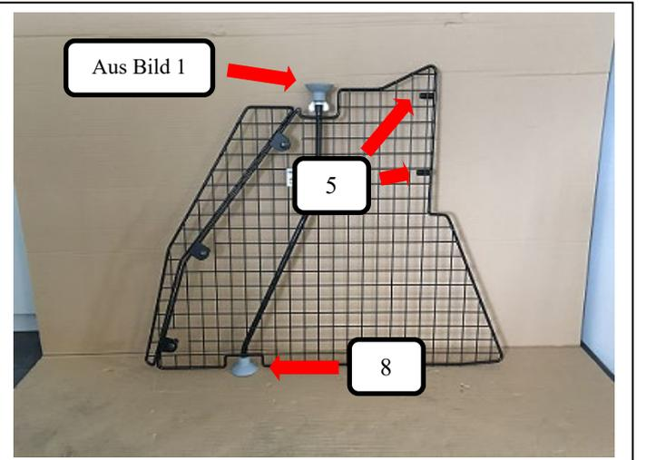
Wie im Bild dargestellt bitte die aus Bild 1 zusammengesteckte Gewindestange mit Gummifuß oben in die Rohröffnung des Teilers stecken (Feststellpunkt) und einen Gummifuß (Pos.8) unten am Teiler aufstecken. Beide Rohrendkappen (Pos. 5) auf den Teiler (Pos. 1) drücken.
