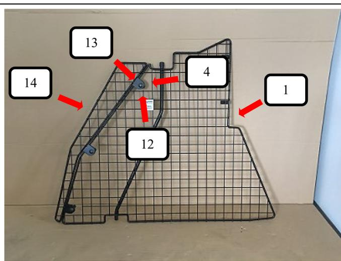
Aufsatz Teiler (Pos. 14) an allen drei Positionen mit einer Schloßschraube (Pos. 12), Unterlegscheibe (Pos. 4) und Rändelmutter flach (Pos. 13) am Teiler (Pos. 1) wie auf Bild 3 aufschrauben und festziehen.
