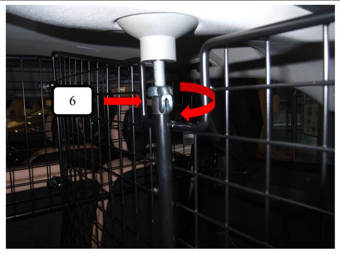
Oberen Feststellunkt über drehen der Flügelmutter (Pos. 6) (Uhrzeigersinn) leicht anziehen.
