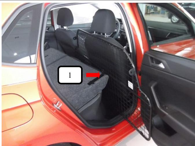
Trenngitter (Pos. 1) von der Seite aus in das Fahrzeug einbringen.
