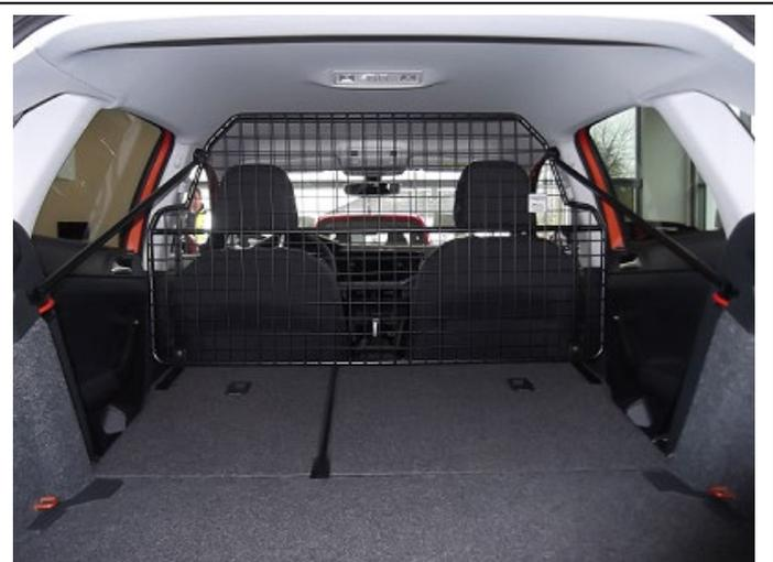
Trenngitter (Pos. 1) im montierten Zustand.
