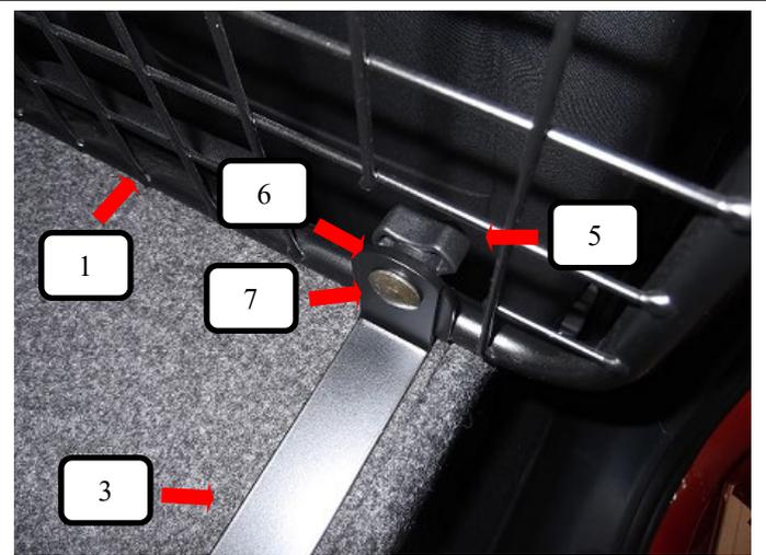
Trenngitter (Pos. 1) mit der Schlossschraube (Pos. 7), Unterlegscheibe (Pos. 6) und Rändelmutter flach (Pos. 5) an der Bodenhalterung (Pos. 3) befestigen und festziehen.
