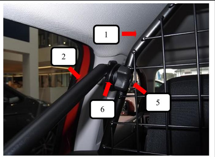
Streben links + rechts (Pos. 2) mit einer Schlossschraube (Pos. 7), Unterlegscheibe (Pos. 6) und Rändelmutter flach (Pos. 5) am Trenngitter (Pos. 1) aufschrauben und festziehen.
