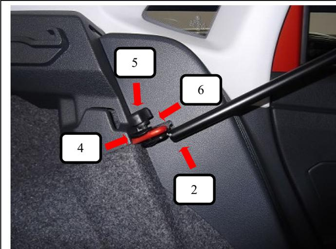
Streben links + rechts (Pos. 2) wie auf dem Bild, mit der Gegenplatte (Pos. 3), Unterlegscheibe (Pos. 6), Rändelmutter flach (Pos. 5) und aufschrauben und festziehen.
