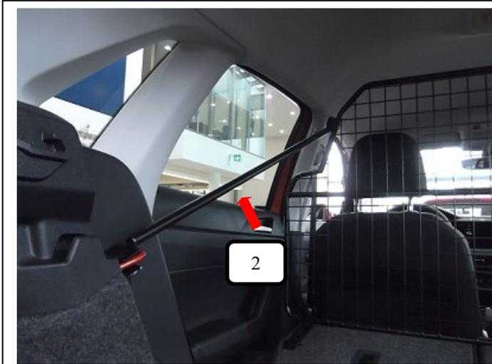
Streben links + rechts (Pos. 2) im montierten Zustand.
