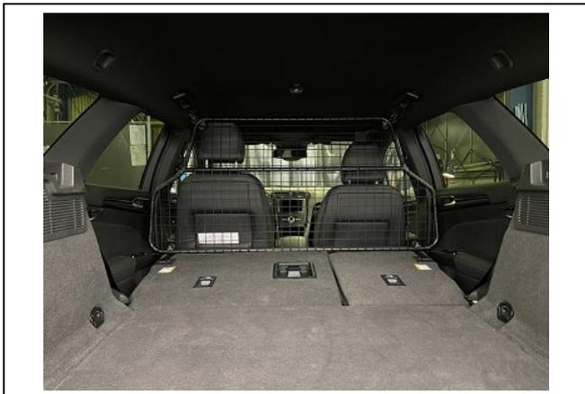
Trenngitter (Pos. 1) ausrichten und alle Verschraubungen festziehen !
