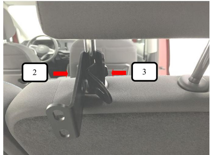
An der mittleren Kopfstütze die Winkelstütze Haken (Pos. 2) wie auf dem Bild um die rechte oder linke Kopfstützenstange führen, jetzt die Winkelstütze Klemmbacke (Pos. 3) in die Winkelstütze Haken (Pos. 2) einklinken.
