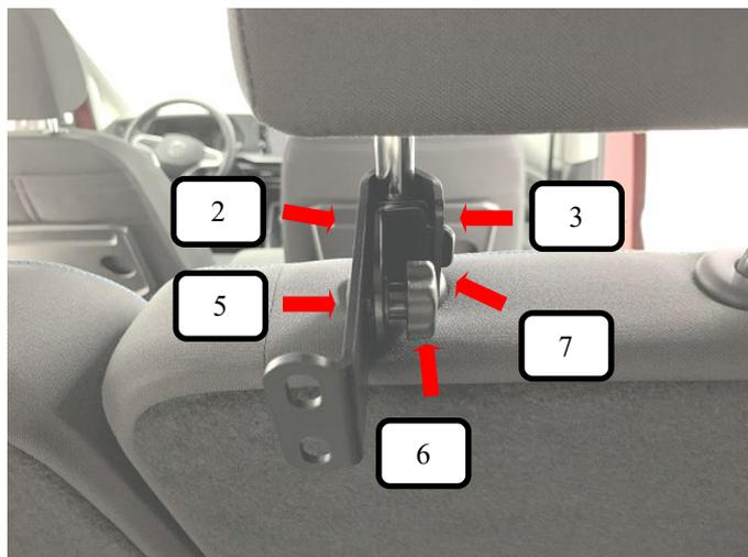
Jetzt an der mittleren Kopfstütze wie auf dem Bild eine Rundkopf-schraube (Pos. 5) durch die Winkelstützen Haken + Klemmbacke (Pos. 2 + 3) stecken und von der anderen Seite eine Unterlegscheibe (Pos. 6) und eine Rändelmutter (Pos. 7) aufschrauben und festziehen.
