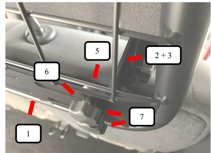
Jetzt das Trenngitter (Pos. 1) vor die montierte Winkelstütze Haken + Klemmbacke (Pos. 2+3) an der äußeren Kopfstütze halten, von vorne eine Rundkopfschraube (Pos. 5) durch die Winkelstütze (Pos. 2+3) und das Trenngitter (Pos. 1) stecken. Jetzt von der anderen Seite eine Unterlegscheibe (Pos. 6) und Rändelmutter (Pos. 7) aufschrauben und festziehen.
