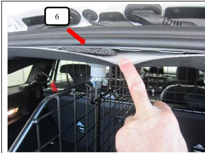
Im oberen Bereich der Hecktür die Gummiabdichtung leicht anheben und je nach gewünschter Position des Teilers die Gummimunterlagen 8mm (Pos.6) im Bereich des Feststellpunktes in den Hohlraum schieben.
