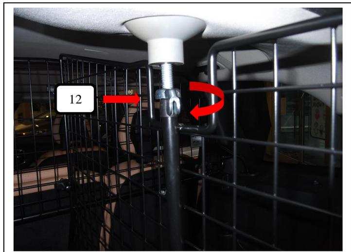
Oberen Feststellpunkt über drehen der Flügelmutter (Pos. 12) (Uhrzeigersinn) leicht anziehen.
