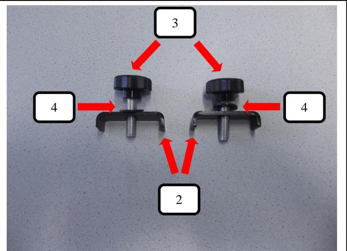
Die beiden U-Bügel (Pos.2) zusammen jeweils einer Unterlegscheibe (Pos.4) und Rändelschraube (Pos.7) wie im Bild dargestellt zusammenbauen.
