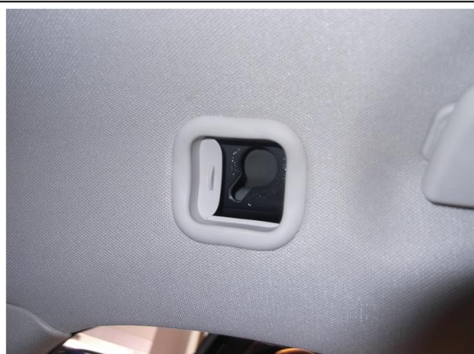
Am Dachhimmel die beiden Haltepunkte durch Wegschieben der Kunststoffverkleidung freilegen.
