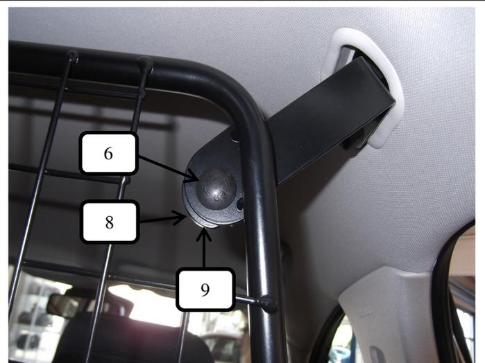
Trenngitter (Pos. 1) ins Fahrzeug einbringen und oben an den Dachhalter mit Schlossschraube (Pos. 6), Unterlegscheibe (Pos. 8) und Rändelmutter (Pos. 9) leicht befestigen.
