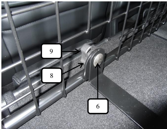
Nun das Trenngitter am Bodenhalter mit Schlossschraube (Pos. 6), Unterlegscheibe (Pos. 8) und Rändelmutter (Pos. 9) leicht befestigen
