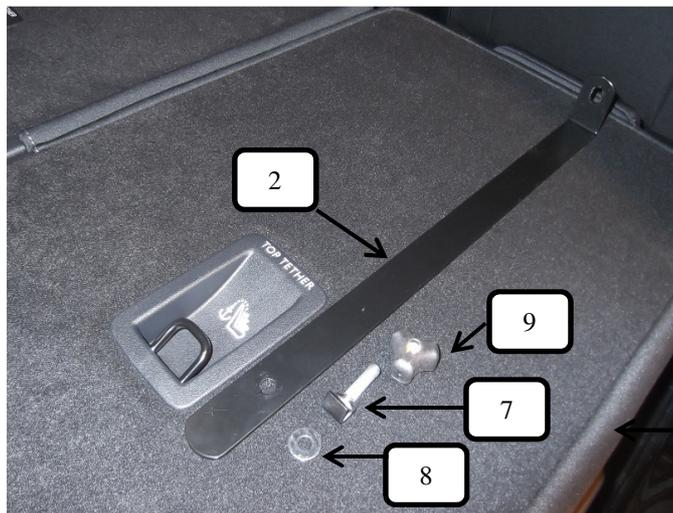
Zur Befestigung der beiden Bodenhalter (Pos. 2) bitte diese selbst, mit jeweils Gewindehaken klein (Pos. 7), Unterlegscheibe (Pos. 8) sowie Rändelmutter (Pos. 9) auf dem beiden äußeren Rücksitzen bereitlegen.
