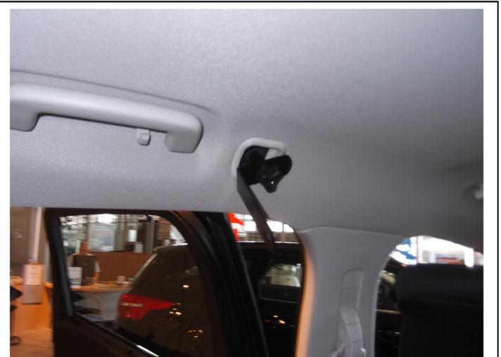
Je nach Fahrzeug (Galaxy oder S-Max) die Dachhalter aus Bild 1 oder Bild 2 (Bitte die Markierung L/R auf den Dachhaltern beachten) mit dem Rundkopf der Schlossschraube in den Haltepunkt einhängen nach unten schieben und mit der Rändelmutter (Pos.9) anziehen. Achten Sie bitte darauf dass die längere Seite der Winkel der Halterung Richtung Heck zeigt.
