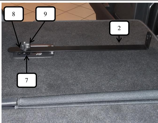
Beide Bodenhalter (Pos. 2) nun zusammen mit der Unterlegscheibe (Pos. 8) und der Rändelmutter (Pos. 9) am Gewindehaken klein (Pos. 7) befestigen.
