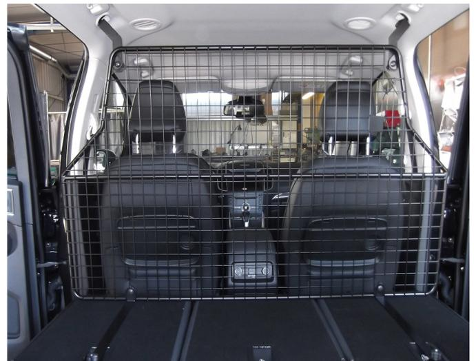
Trenngitter final ausrichten und alle Befestigungspunkte fest anziehen
