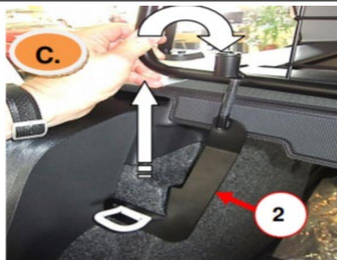
Trenngitter in das Fahrzeug einbringen und hinter der C-Säule positionieren. Den Gewindehaken (Pos. 2) über die Rückenlehnen-Verankerung führen, jetzt das Trenngitter leicht anheben und das Gewinde durchschieben.
