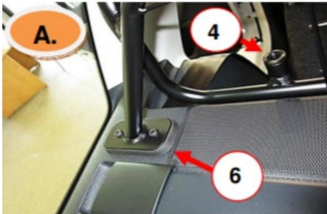
Schutzauflage groß (Pos.6) von unten auf die Auflageplatten und die Kunststoffhülse (Pos.4) von oben in das Trenngitter (Pos. 1) stecken.
