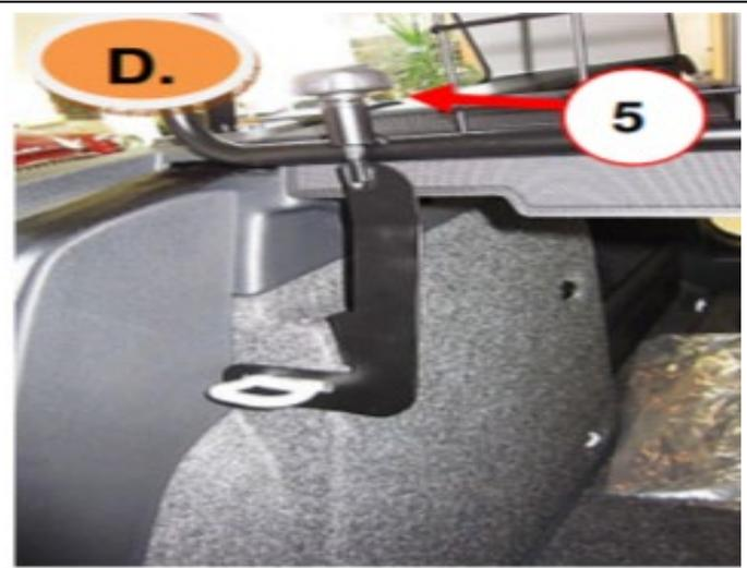
Rändelmutter (Pos. 5) aufschrauben und festziehen, nur so fest anziehen bis das Trenngitter spielfrei fixiert ist. Jetzt können die Rücksitzlehnen wieder hochgeklappt werden.
