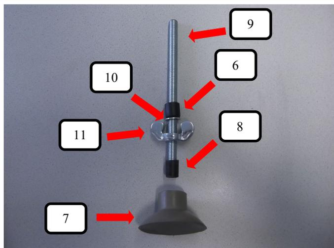
Auf die Gewindestange oben (Pos.9) eine Distanzhülse (Pos. 8) und dann einen Gummifuß grau (Pos.7) wie im Bild dargestellt aufstecken. Danach die Flügelmutter (Pos. 11) drauf drehen und die Unterlegscheibe (Pos. 10), sowie die Duschführungskappe f. Gewindestange (Pos. 6) aufschieben.
