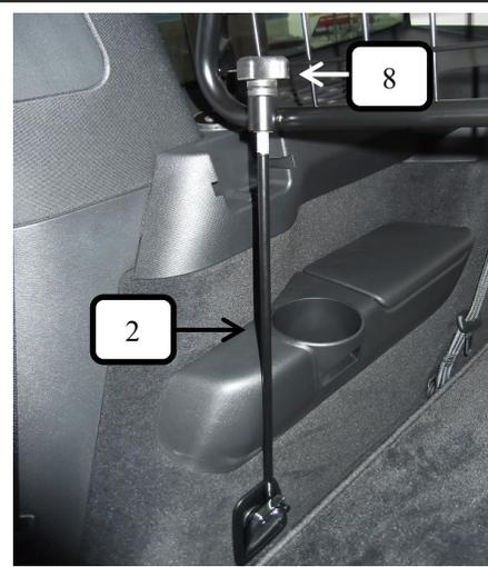
Gewindehaken (Pos.2) jeweils rechts und links unten an der Verzurrösenhalterung einhängen, durch die Hülsen am Trenngitter stecken und mit den Rändelmuttern gewölbt (Pos. 8) leicht anziehen.
