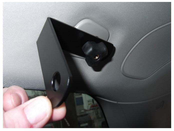
Wie im Bild dargestellt, die aus Bild 1 zusammengebauten Winkel jeweils rechts und links oben in den Fahrzeugseitigen Aufnahmeösen einhängen, festhalten und leicht anziehen.
