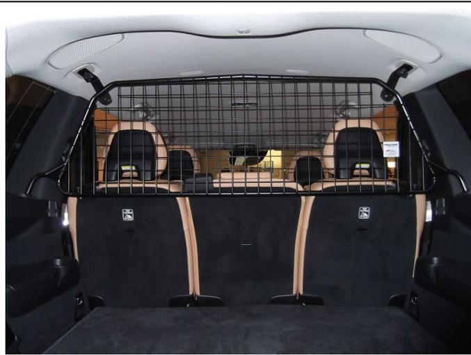
Trenngitter vom Kofferraum aus in Fahrzeug einbringen
