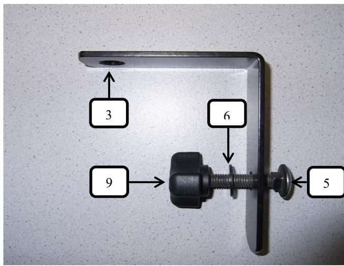
Die beiden Winkel (Pos.3) zusammen mit je einer Schlossschraube M8 (Pos.5), Unterlegscheibe (Pos. 6) und Rändelmutter flach (Pos. 9) wie im Bild dargestellt lose zusammenbauen.
