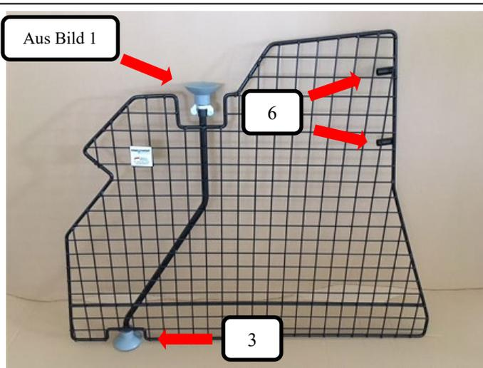
Wie im Bild dargestellt bitte die aus Bild 1 zusammengesteckte Gewindestange mit Gummifuß oben in die Rohröffnung des Teilers stecken (Feststellpunkt) und einen Gummifuß (Pos.3) unten am Teiler aufstecken. Beide Rohre (Pos. 6) auf den Teiler (Pos. 1) drücken.
