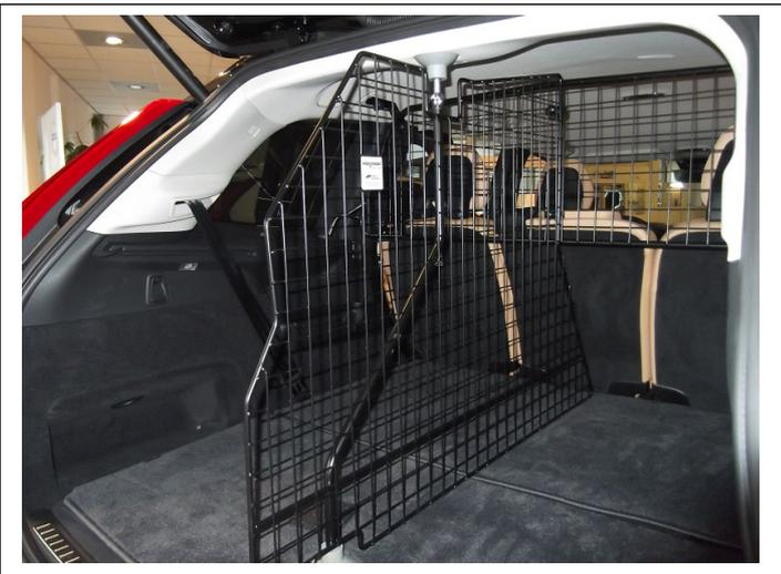
Teiler ggf. leicht ausrichten und final befestigen.
