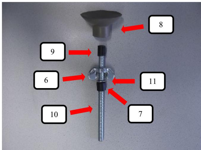
Auf die Gewindestange oben (Pos.10) die Distanzhülse (Pos. 9) und danach den Gummifuß (Pos. 8) aufstecken. Von der anderen Seite die Flügelmutter (Pos. 6) aufdrehen und dann die U-Scheibe (Pos. 11) und Durchführungskappe für Gewindestange (Pos. 7) aufschieben.
