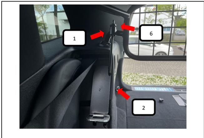
Trenngitter (Pos. 1) von hinten aus in das Fahrzeug einbringen und an der C-Säule platzieren. Nun den Gewindehaken (Pos. 2) über die Rücksitzbankretterung führen, jetzt das Trenngitter (Pos. 1) leicht anheben und den Gewindehaken L+R (Pos. 2) durch die Kunststoffhülse (Pos. 6) führen.
