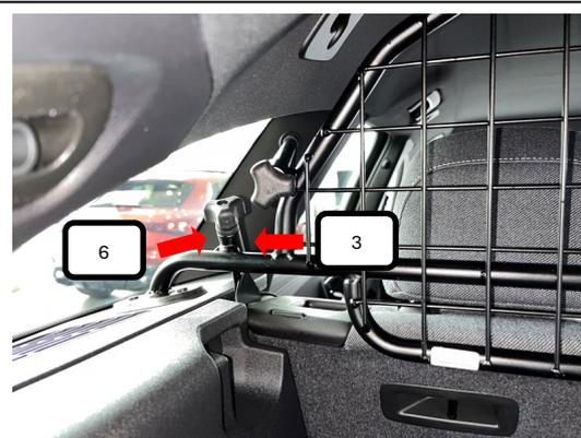
Nun die Rändelmutter gewölbt (Pos. 6) auf das Gewinde des Gewindehaken L+R (Pos. 3) aufschrauben und festziehen.
