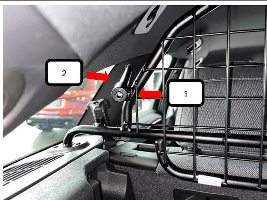
Das 16er Rohr mit Innengewinde (Pos. 2), mit dem Innengewinde in das Trenngitter (Pos. 1) stecken.
