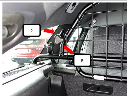
Jetzt die Rändelschraube M8x30 (Pos. 5) in das 16er Rohr mit Innengewinde (Pos. 2) schrauben und festziehen.
