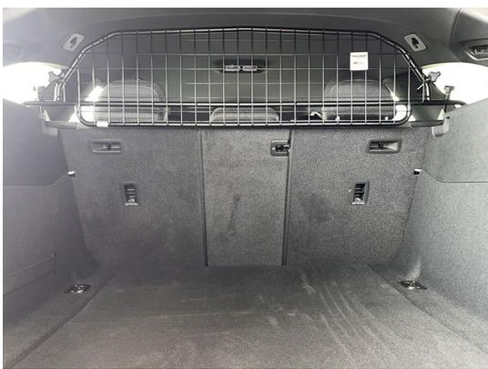
Trenngitter im montierten Zustand.
