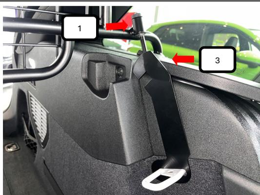
Gewindehaken L+R (Pos. 3) über die Rücksitzbankarretierung führen, Trenngitter (Pos. 1) leicht anheben und jetzt das Gewinde des Gewindehaken L+R (Pos. 3) durch das Trenngitter (Pos. 1) führen.
