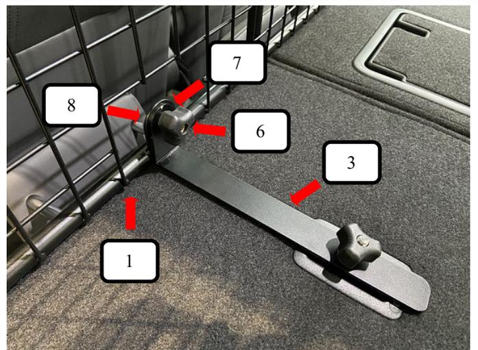
Trenngitter (Pos. 1) vor die montierten Bodenhalter (Pos. 3) stellen, von vorne eine Schlossschraube (Pos. 8) durch das Trenngitter (Pos. 1) und Bodenhalter (Pos. 3) stecken. Von der anderen Seite eine Unterlegscheibe (Pos. 7) und Rändelmutter flach (Pos. 6) aufschrauben und festziehen.
