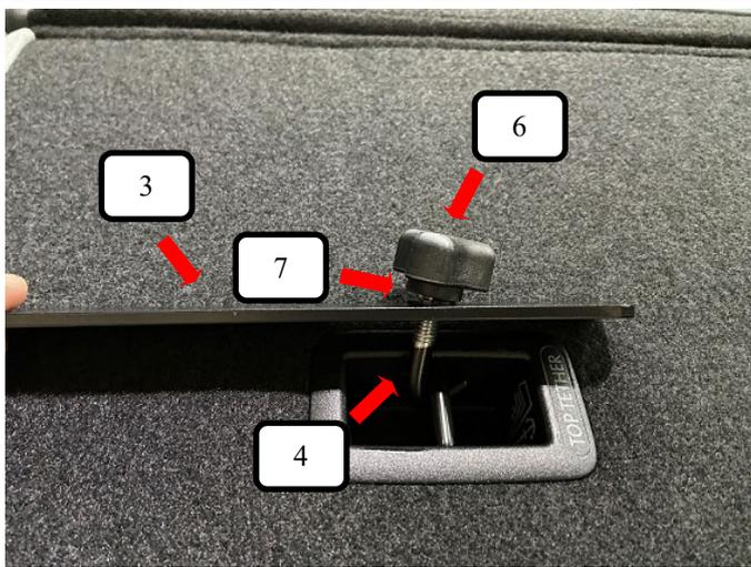
Gewindehaken (Pos. 4) von unten durch den Bodenhalter (Pos. 3) stecken, von oben leicht die Unterlegscheibe (Pos. 7) und Rändelmutter flach (Pos. 6) aufschrauben. Jetzt wie auf dem Bild den Gewindehaken (Pos. 4) in die Rücksitzbankverankerung einhängen und festziehen.
