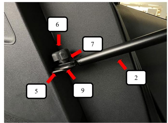
Die andere Seite der Stützstrebe L+R (Pos. 2) auf die Rücksitzbankverankerungen legen, von unten die Gegenplatte (Pos. 5) anhalten und auch von unten eine Schlossschraube (Pos. 9) durchstecken. Jetzt von oben eine Unterlegscheibe (Pos. 7) und Rändelmutter flach (Pos. 6) aufschrauben und festziehen.
