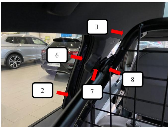
Stützstrebe L+R (Pos. 2) von außen an das Trenngitter (Pos. 1) halten, von innen eine Schlossschraube (Pos. 8) durchstecken und von der Außenseite eine Unterlegscheibe (Pos. 7) und Rändelmutter flach (Pos. 6) aufschrauben und festziehen.
