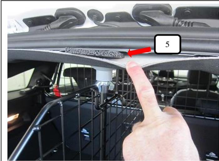
Teiler ins Fahrzeug einbringen und in gewünschte Position bringen. Im oberen Bereich der Heckklappe die Gummiabdichtung leicht anheben und je nach gewünschter Position des Teilers 2 x die Gummimunterlagen 8mm (Pos.5) im Bereich des Feststellpunktes in den Hohlraum schieben.
