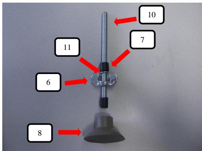
Die Gewindestange oben (Pos.10) auf einen Gummifuß grau (Pos.8) wie im Bild dargestellt aufstecken. Danach die Flügelmutter (Pos. 6) drauf drehen und die Unterlegscheibe (Pos. 11), sowie die Durchführungsschutzkappe (Pos. 7) aufstecken.
