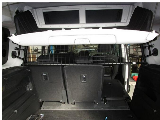
Trenngitter im montierten Zustand.
