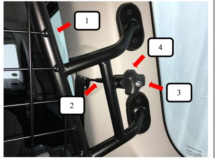
Gewindehaken (Pos.2) in die hintere Ecke der Gurtaustrittöffnung einhängen und Gewindehaken (Pos. 2) durch die Kunststoffhülse (Pos. 4) am Trenngitter (Pos. 1) stecken. Rändelmutter (Pos.3) aufschrauben und festziehen.
