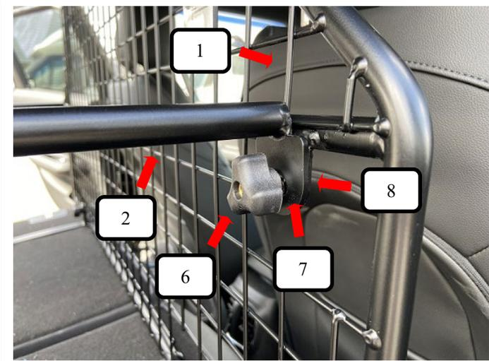
Strebe rechts + links (Pos. 2) an das Trenngitter (Pos. 1) halten, von vorne eine Rundkopfschraube (Pos. 8) durchstecken und von der anderen Seite eine Unterlegscheibe (Pos. 7) sowie Rändelmutter flach (Pos. 6) aufschrauben und festziehen.
