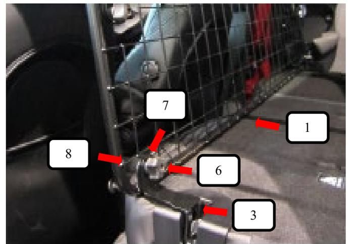
Trenngitter (Pos. 1) von der Seite aus in das Fahrzeug einbringen und vor den Bodenhalter (Pos. 3) stellen. Jetzt von vorne eine Rundkopfschraube (Pos. 8) durch das Trenngitter (Pos. 1) und den Bodenhalter (Pos. 3) stecken. Von der anderen Seite eine Unterlegscheibe (Pos. 7) und Rändelmutter flach (Pos. 6) aufschrauben und festziehen.
