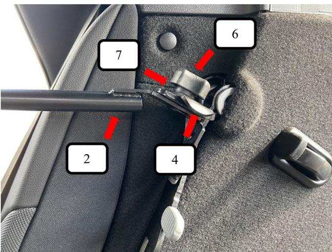
Streben rechts + links (Pos. 2) von unten an die Rücksitzbank-arretierung halten, so dass, das Gewinde durch ragt. Von oben die Gegenplatte auflegen und jetzt eine Unterlegscheibe (Pos. 7) sowie Rändelmutter flach (Pos. 6) aufschrauben und festziehen.
