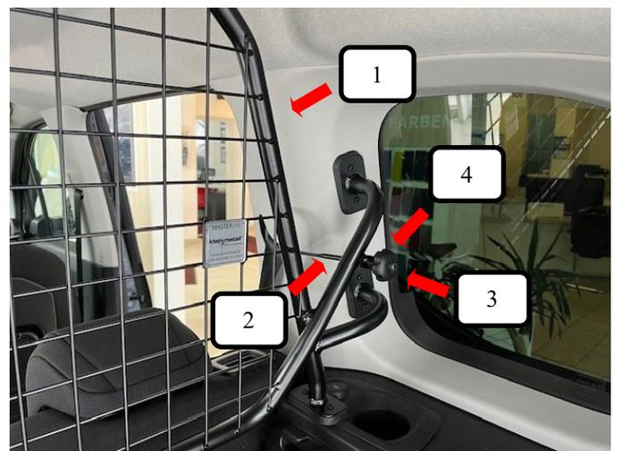
Gewindehaken (Pos.2) in die hintere Ecke der Gurtaustrittsöffnung einhängen und Gewindehaken (Pos. 2) durch die Kunststoffhülse (Pos. 4) am Trenngitter (Pos. 1) stecken. Rändelmutter (Pos.3) aufschrauben und festziehen.
