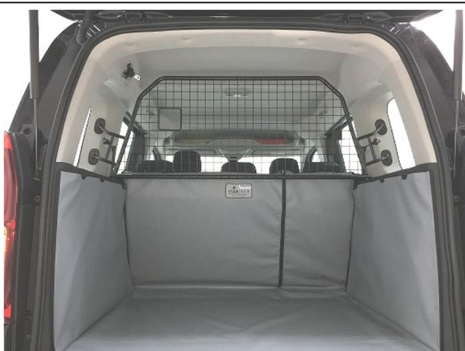
Trenngitter im montierten Zustand.
