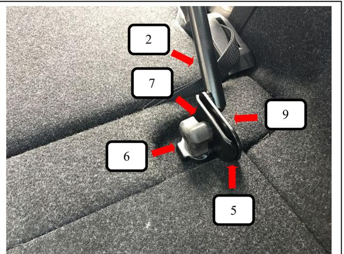
Streben links + rechts (Pos. 2) an die hochgestellte Verzurröse halten, mit einer Schlossschraube (Pos. 9), Unterlegscheibe (Pos. 7), Gegenplatte (Pos. 5) und Rändelmutter flach (Pos. 6) verbinden. Beim festziehen muss das Ganze leicht nach außen geneigt werden, da sich sonst die Rändelmutter (Pos. 6) nicht richtig drehen lässt.
