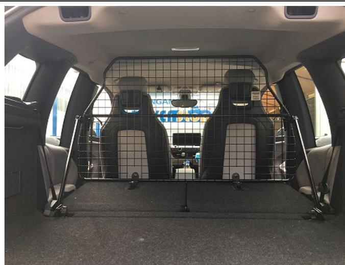
Trenngitter im montierten Zustand.
