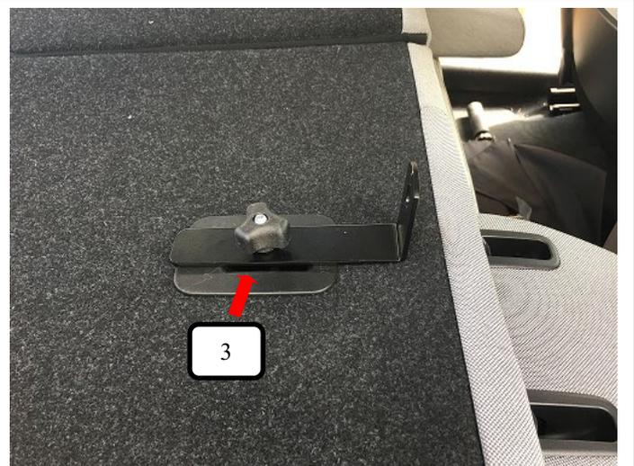
Vormontierte Bodenhalterungen aus Bild 1, von hinten in die Isofix-Halterung eingehängen und festziehen.
