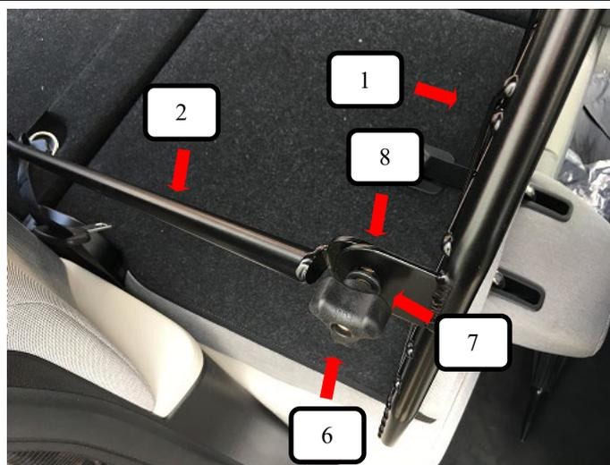
Streben links + rechts (Pos. 2) von innen an das Trenngitter (Pos. 1) halten. Mit einer Schlossschraube (Pos. 8), Unterlegscheibe (Pos. 7) und Rändelmutter flach (Pos. 6) am Trenngitter (Pos. 1) verbinden und festziehen.
