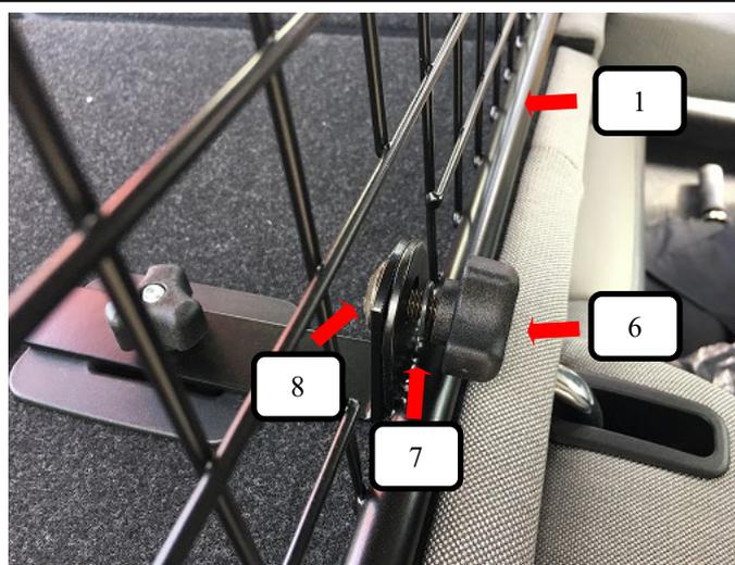
Trenngitter (Pos. 1) von der Seite aus in das Fahrzeug einbringen und vor die montierte Bodenhalterung (Pos. 3) aus Bild 2 stellen. Mit einer Schlossschraube (Pos. 8), Unterlegscheibe (Pos. 7) und Rändelmutter flach (Pos. 6) verbinden und festziehen.
