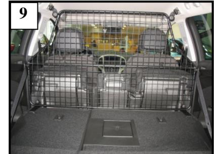
**Trenngitter darf nur in Verbindung mit eingebauten und aufrechtstehenden Vordersitzen verwendet werden !**
