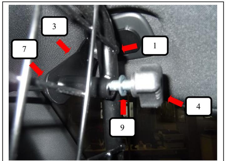
Trenngitter (Pos. 1) in das Fahrzeug einbringen, mit einer Schlossschraube (Pos. 7), Unterlegscheibe (Pos. 9) und Rändelmutter flach (Pos. 5) an dem Dachhalter links + rechts (Pos. 3) aufschrauben und festziehen.
