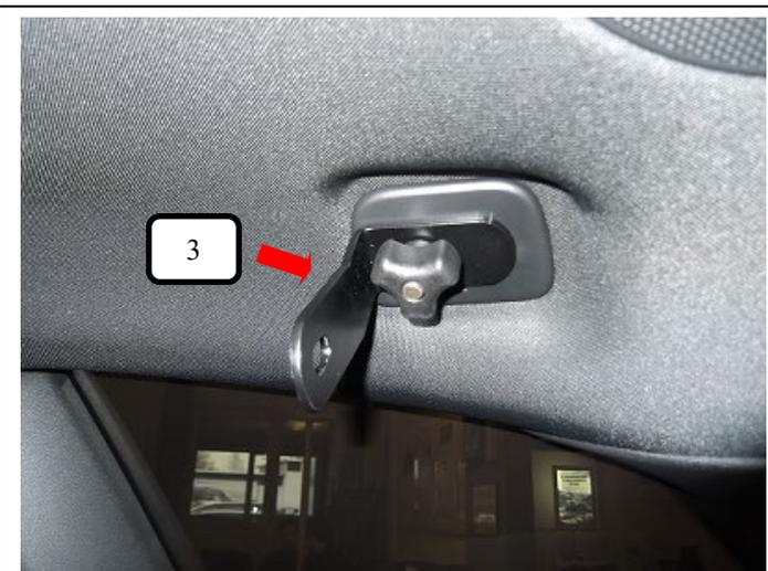
Dachhalter links + rechts (Pos. 3) wie auf Bild 2 vormontiert, mit der Schlossschraube (Pos. 8) in die vorhandenen Netzaufhängungen einhängen und mit der Rändelmutter flach (Pos. 5) festziehen.
