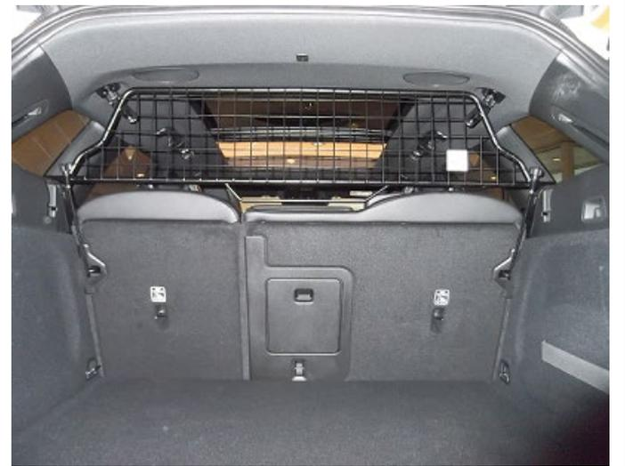
Trenngitter (Pos. 1) im montierten Zustand.
