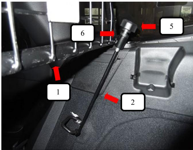
Gewindehaken (Pos. 2) über die Rücksitzbankverankerung stecken, dann durch das Trenngitter (Pos. 1) und die Kunststoffhülse (Pos. 6) führen. Rändelmutter gewölbt (Pos. 5) auf den Gewindehaken (Pos. 2) aufschrauben und festziehen.
