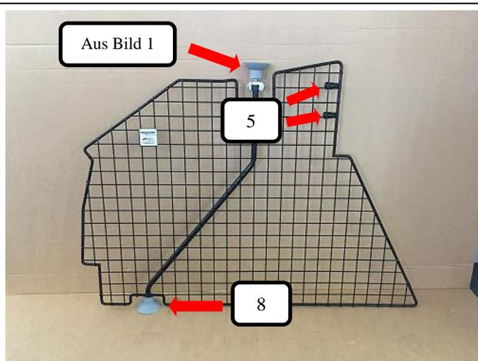
Wie im Bild dargestellt bitte die aus Bild 1 zusammengesteckte Gewindestange mit Gummifuß oben in die Rohröffnung des Teilers stecken (Feststellpunkt) und einen Gummifuß (Pos.8) unten am Teiler aufstecken. Beide Rohrendkappen (Pos. 5) auf den Teiler (Pos. 1) drücken.
