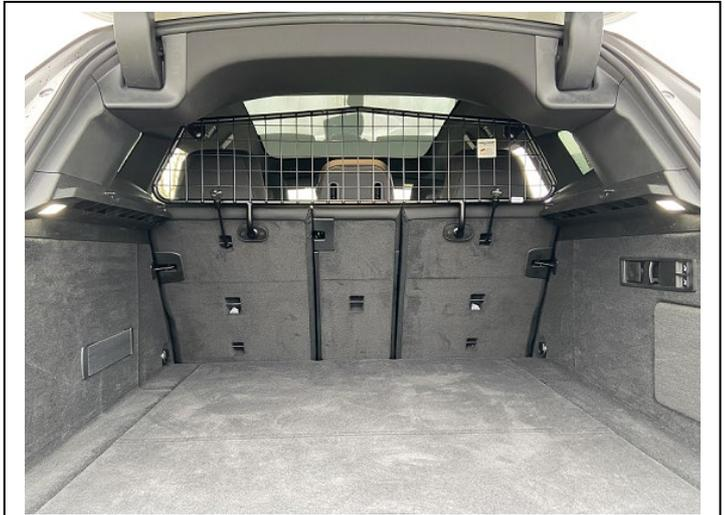
Trenngitter im montierten Zustand.
