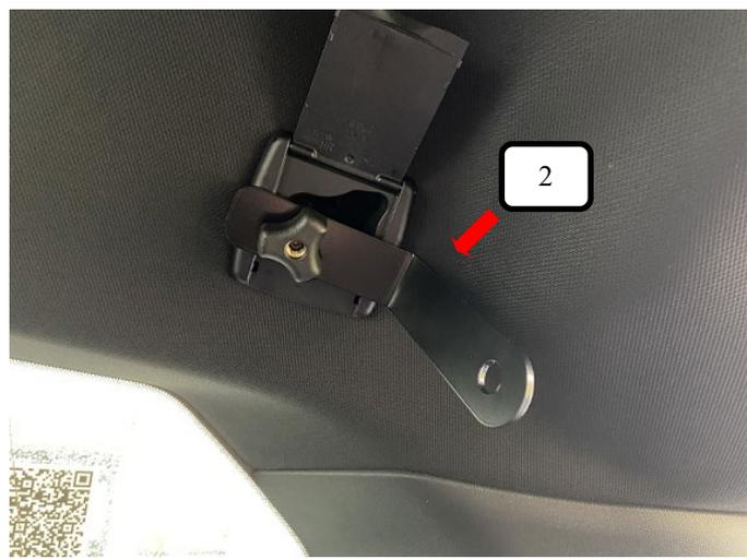
Vormontierte Dachhalter (Pos. 2) aus Bild 2, in die vorhandenen Netzaufhängungen einhängen und festziehen.
