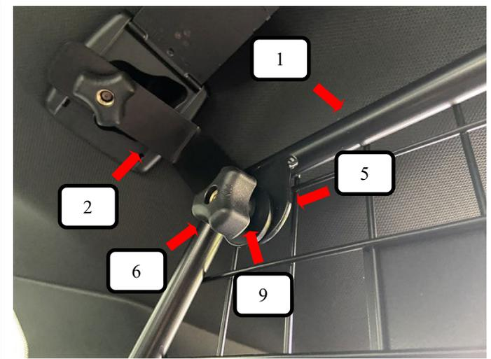
Trenngitter (Pos. 1) in das Fahrzeug einbringen und an den Dachwinkel (Pos. 2) platzieren. Jetzt von hinten eine Schlossschraube M8x20 (Pos. 5) durch das Trenngitter (Pos. 1) und den Dachwinkel (Pos. 2) stecken, von der anderen Seite eine Unterlegscheibe (Pos. 9) und Rändelmutter flach (Pos. 6) aufschrauben und festziehen.
