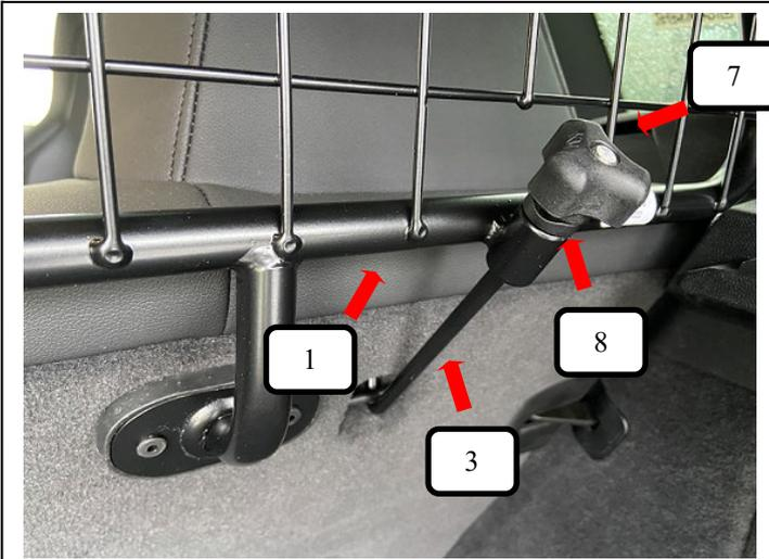
Gewindehaken (Pos. 3) wie auf dem Bild in die Verankerung einhängen und durch das Trenngitter (Pos.1) und Kunststoffhülse (Pos. 8) schieben, jetzt die Rändelmutter gewölbt (Pos. 7) aufschrauben und festziehen.
