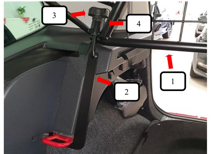
Gewindehaken L+R (Pos. 2) wie auf dem Bild unten an der Rückbankankarretierung einhängen und durch das Trenngitter (Pos. 1) sowie Kunststoffhülse (Pos. 4) führen. Jetzt eine Rändelmutter gewölbt (Pos. 3) aufschrauben und festziehen.
