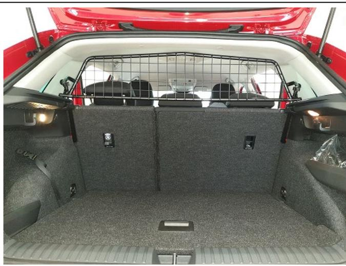
Trenngitter im montierten Zustand.
