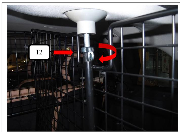
Oberen Feststellpunkt über drehen der Flügelmutter (Pos. 12) (Uhrzeigersinn) leicht anziehen.
