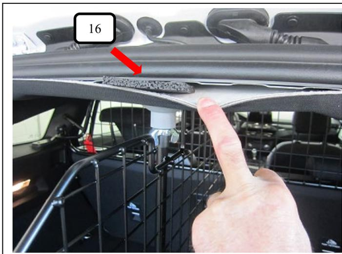
Im oberen Bereich der Hecktür die Gummiabdichtung leicht anheben und je nach gewünschter Position des Teilers die 2 x Gummunterlagen 8mm (Pos.6) im Bereich des Feststellpunktes in den Hohlraum schieben.
