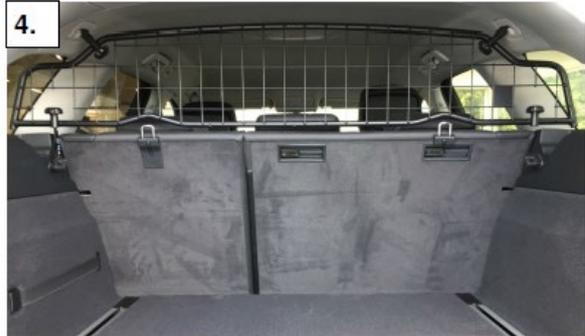
Trenngitter im montierten Zustand.
