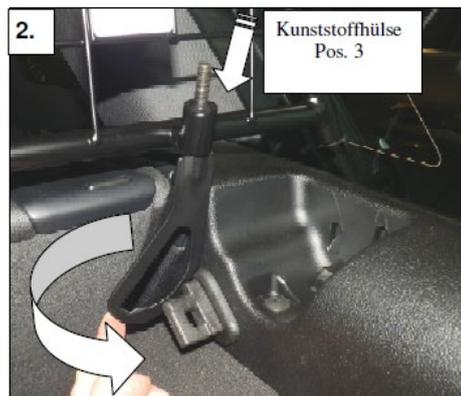
Halterungen (Pos. 1) in die Kunststoffhülsen (Pos. 3) am Trenngitter stecken und über die Verankerung am Fahrzeug schwenken.
