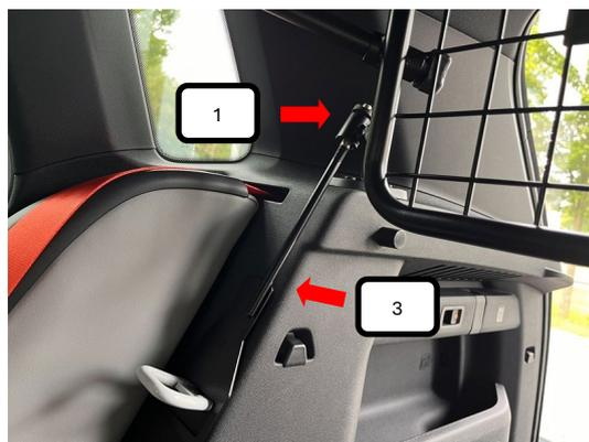
Gewindehaken L+R (Pos. 3) über die Rücksitzbankarretierung führen, danach das Gewinde durch das Trenngitter (Pos. 1) stecken (Gitter muss dafür leicht angehoben werden).
