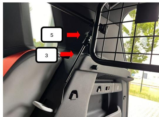
Jetzt die Rändelmutter gewölbt (Pos. 5), auf den Gewindehaken L+R (Pos. 3) aufschrauben und festziehen.
