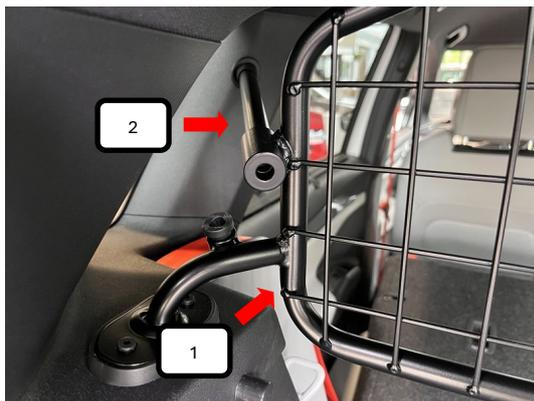
Trenngitter (Pos. 1) von hinten auf in das Fahrzeug einbringen und vor der C-Säule platzieren. Jetzt das vormontierte 16er Rohr (Pos. 2) aus Bild 4, in das Trenngitter (Pos. 1) schieben.
