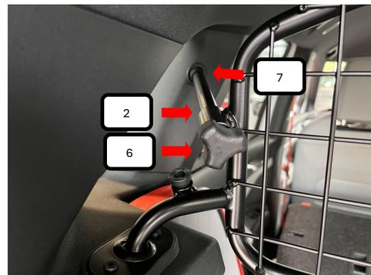
Nun die Rändelschraube M8x30 (Pos. 6) reindreihen und festziehen, es muss darauf geachtet werden, dass der Gummifuß 25° (Pos. 7) der Schräge der C-Säule angepasst ist.
