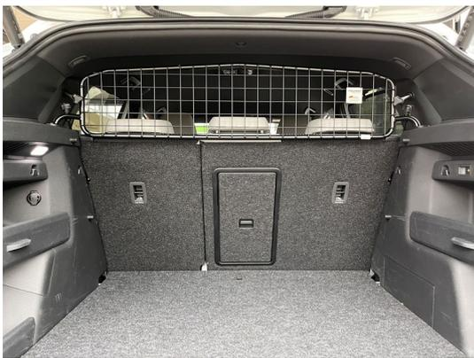
Trenngitter im montierten Zustand.
