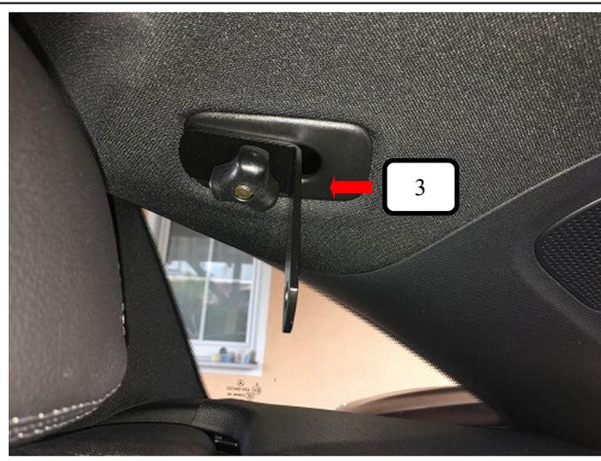
Vormontierten Dachhalter (Pos. 3) aus Bild 1, in die vorhandenen Original-Netzaufhängungen einhängen und anziehen.
