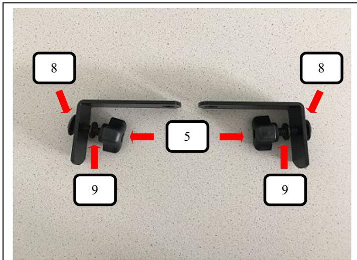
Dachhalter (Pos. 3) wie auf dem Bild mit einer Schlossschraube (Pos. 8), Unterlegscheibe (Pos. 9) und Rändelmutter flach (Pos. 5) vormontieren.
