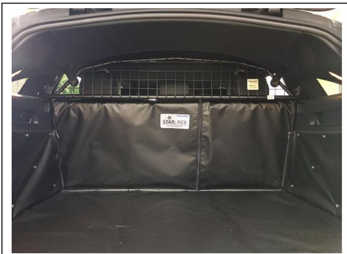
Trenngitter im montierten Zustand.
