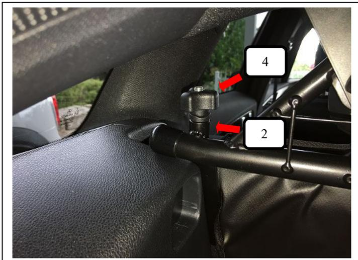
Jetzt eine Rändelmutter gewölbt (Pos. 4) auf den Gewindehaken L+R (Pos. 2) aufschrauben und festziehen.
