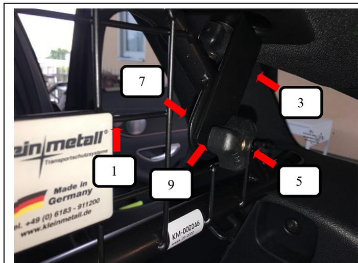
Trenngitter (Pos. 1) in das Fahrzeug einbringen, jetzt den Dachhalter (Pos. 3) mittels einer Schlossschraube (Pos. 7), Unterlegscheibe (Pos. 9) und Rändelmutter flach (Pos. 5) am Trenngitter (Pos. 1) befestigen und festziehen.
