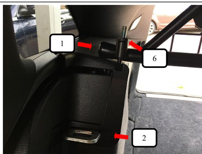
Gewindehaken L+R (Pos. 2) über die Rücksitzbank-Arretierungspunkte schieben und das Gewinde oben durch das Trenngitter (Pos. 1) sowie Kunststoffhülse (Pos. 6) stecken.
