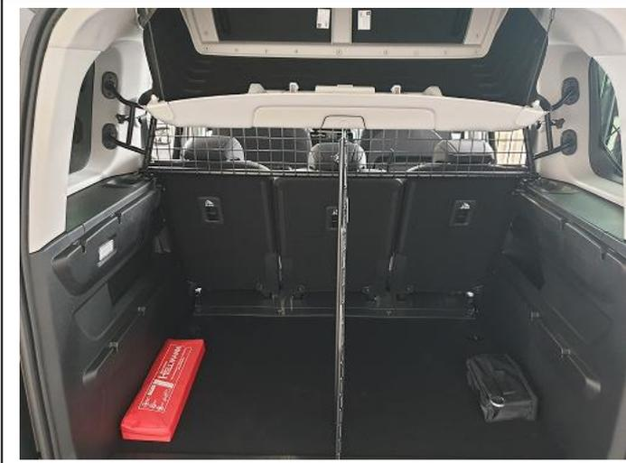
Raumteiler im montierten Zustand, mit offenem Ablagefach.
