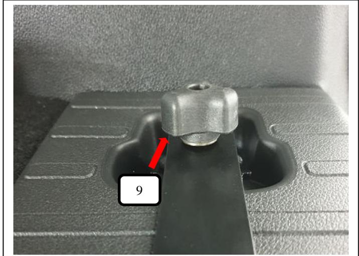
Rändelmutter flach (Pos. 9) aufschrauben und festziehen.
