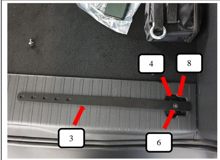
Schlossschraube (Pos. 8) durch die Gegenplatte (Pos. 4) stecken und unter die Verzurröse (Pos. 3) legen. Von oben den Bodenhalter (Pos. 3) und eine Unterlegscheibe (Pos. 6) über die Schlossschraube (Pos. 8) führen.
