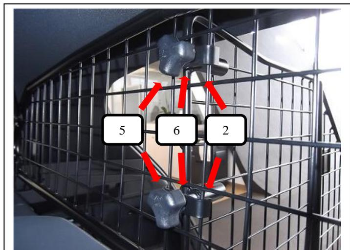
Die beiden U-Bügel (Pos. 2) zusammen von vorne mit jeweils einer Unterlegscheibe (Pos. 6) und Rändelschraube (Pos. 5), oben und unten am Trenngitter befestigen.
