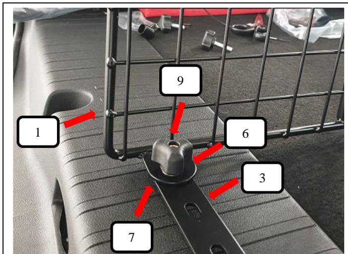
Schlossschraube (Pos. 7) von unten in der gewünschten Position durch den Bodenhalter (Pos. 3) und Raumteiler (Pos. 1) stecken, von oben eine Unterlegscheibe (Pos. 6) und Rändelmutter flach (Pos. 9) aufschrauben und festziehen.
